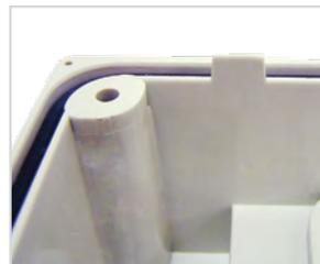
Специальные направляющие, расположенные по периметру корпуса, позволяют быстро совместить отверстия для соединения основания с крышкой, а лабиринтное уплотнение позволяет защитить оборудование в среде со степенью до IP65.
