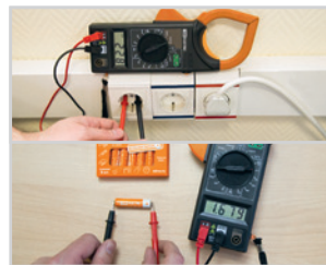
Измерение постоянного и переменного напряжения и тока.
