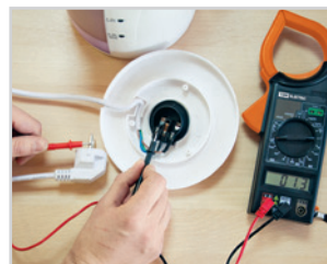
Измерение напряжения в цепи. Проверка целостности цепей.
