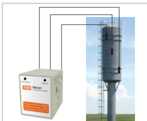
Автоматический контроль уровня воды в водонапорной башне.
